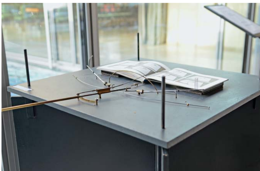
Eine der vier „Umblättermaschinen“: Mit zwei Handgriffen können die Seiten gewendet werden, ohne dass man das Papier mit der Hand berühren muss.
