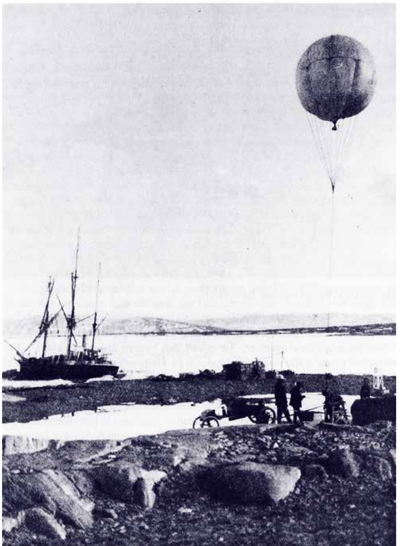
Abb. 2: Fesselballonaufstieg in Danmarks Havn, Sommer 1906. Als Motorwinde wird ein Automotor verwendet.
